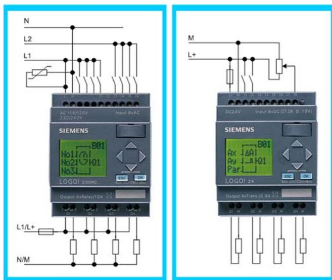
Выходы выполнены в виде изолированных друг от друга контактов реле. Для питания нагрузки необходим внешний источник питания. Цепь питания нагрузки рекомендуется защищать 16А автоматическим выключателем с характеристикой В16 (например, 6SX2 116-6).
