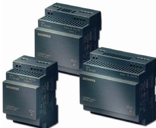
Модули крепятся на 35 мм профильные шины DIN в вертикальном положении (клеммы для подключения внешних цепей вверху). Для обеспечения нормальных условий охлаждения вокруг каждого блока питания оставляются монтажные зазоры шириной 2 см.
